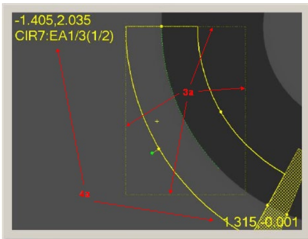
PC-DMIS 影像测量 - 活动视图展示了 ROI 和 FOV 坐标系
