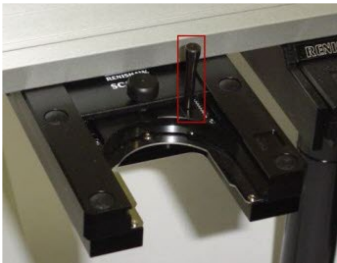
SCP600 测头更换架显示由探针扳手开启的空端口
