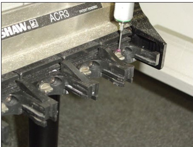
端口 4 背面的第二个手动测头测点的视图
