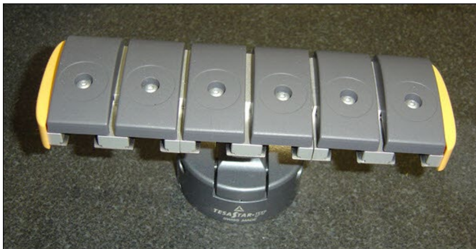
TESASTAR-PR / HR-P 测头更换架
