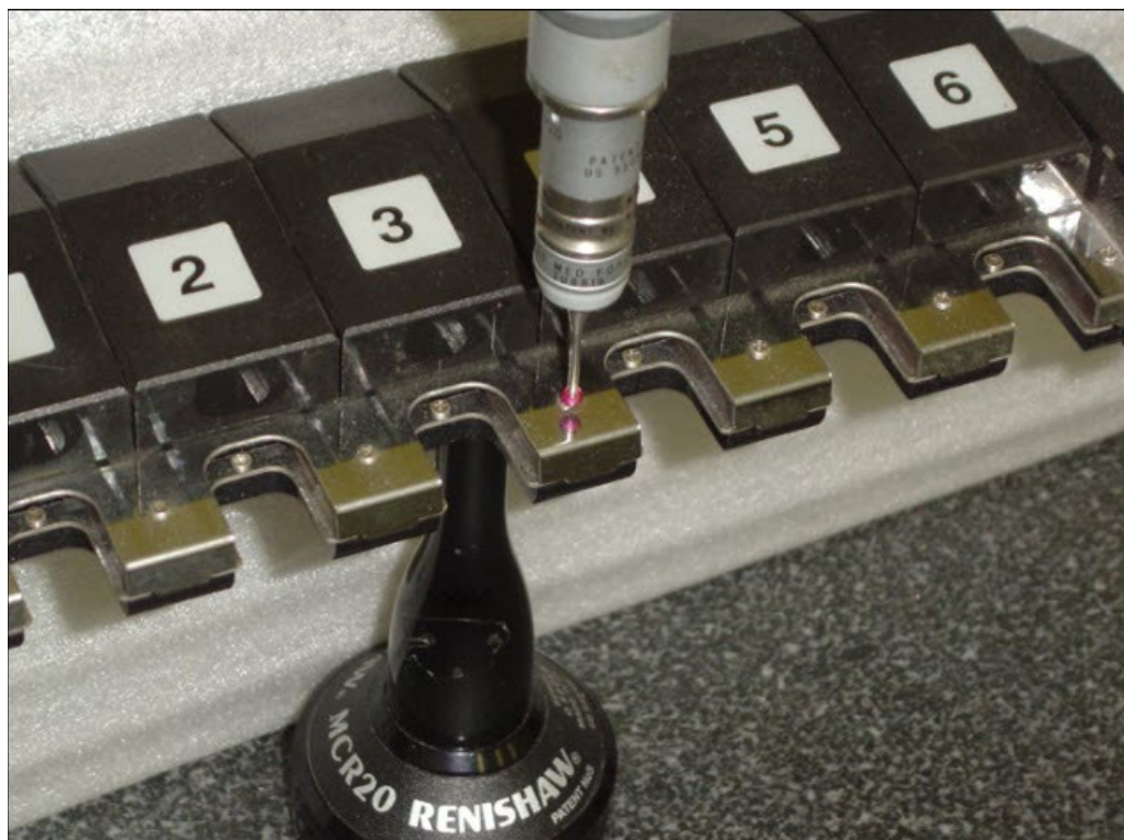
TP20 校准期间第二个手动测点的位置
