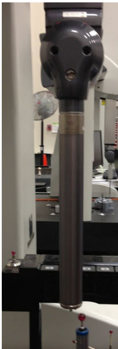
使用测量机示教盒，在使用空扩展的基准球顶部采集手动测点
