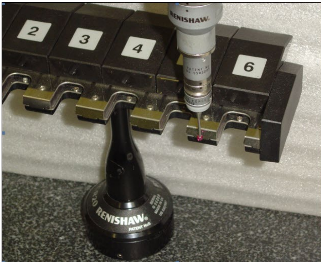
TP20 校准期间第三个手动测点的位置
