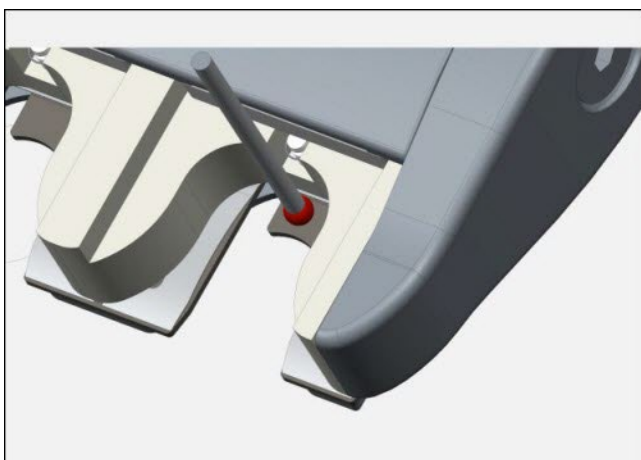
在端口背面的测头支撑件的顶部表面上进行第四次触测的视图
