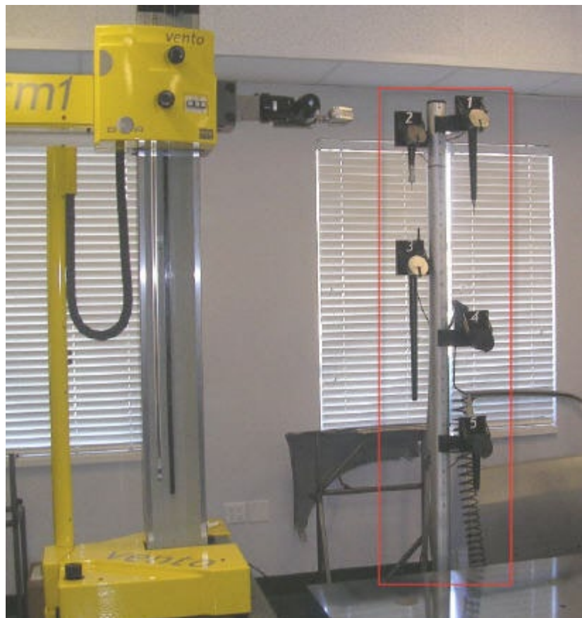
5 个端口的 CW43 垂直测头更换架
