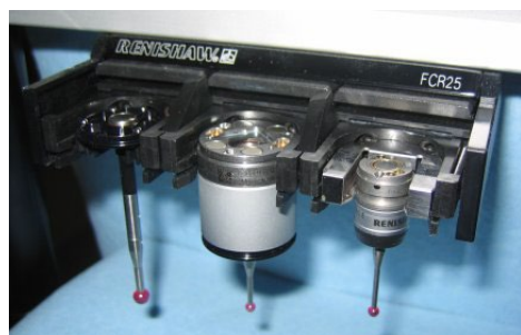
FCR25 测头更换架插入件和测头类型
