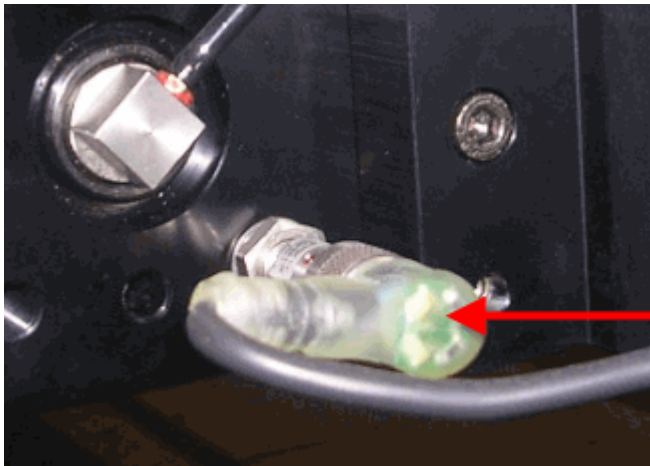
螺线管连接了绿色和黄色 LED 灯
