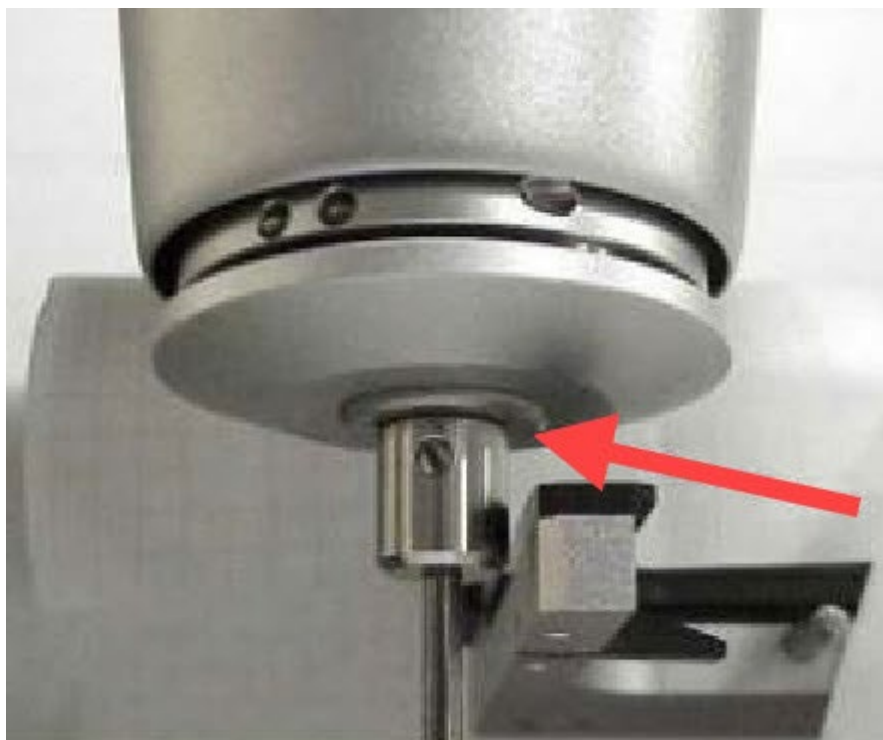
库位 1 夹钳顶部第一个测点位置
