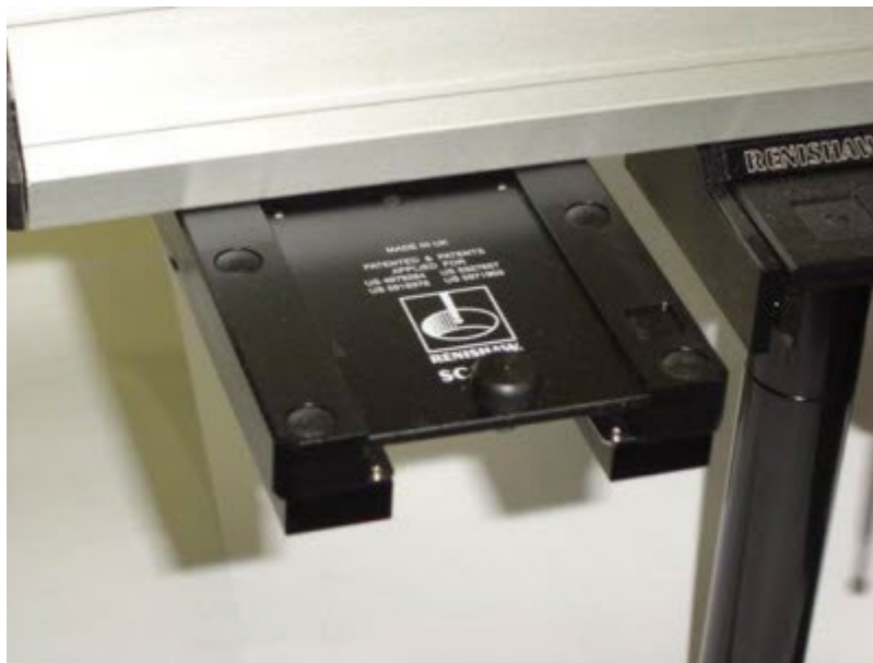
雷尼绍 (Renishaw) SCP600 测针更换架
