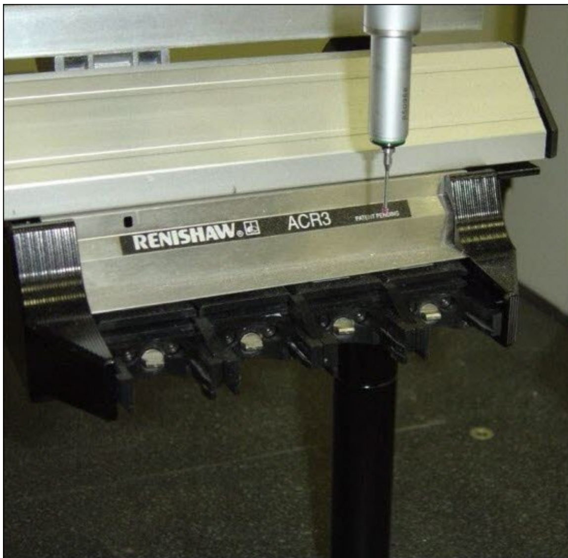
显示端口为空、透过垫片保持打开的 ACR3 测头更换架
