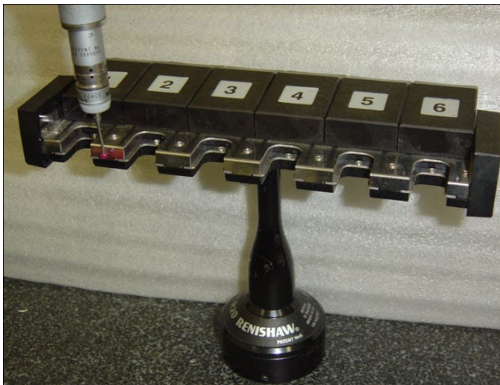
TP20 校准期间第一个手动测点的位置
