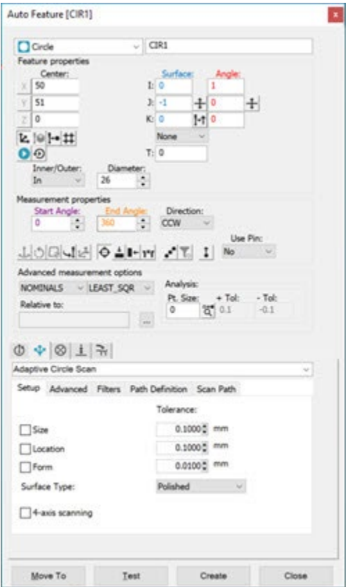
圆形自动特征对话框，带有用于自适应圆扫描的 4 轴扫描选项
