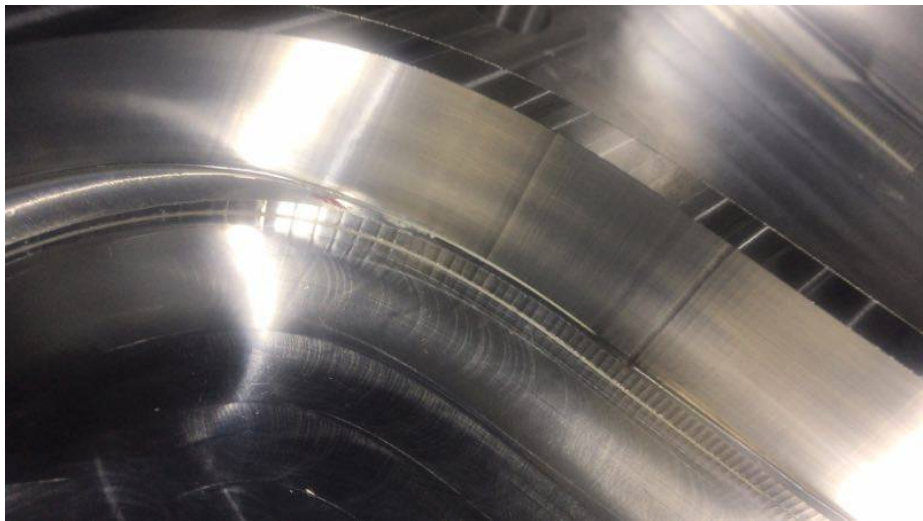
图 7 实际加工缺陷的“S”件
