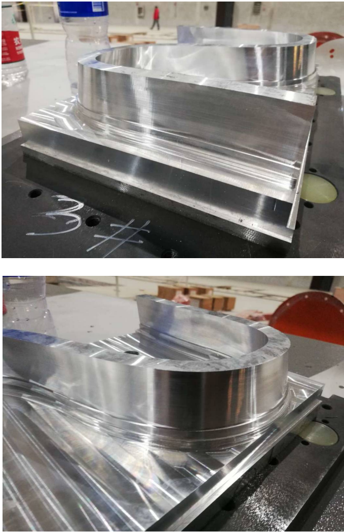
图 3-12 S 件优化后加工效果
